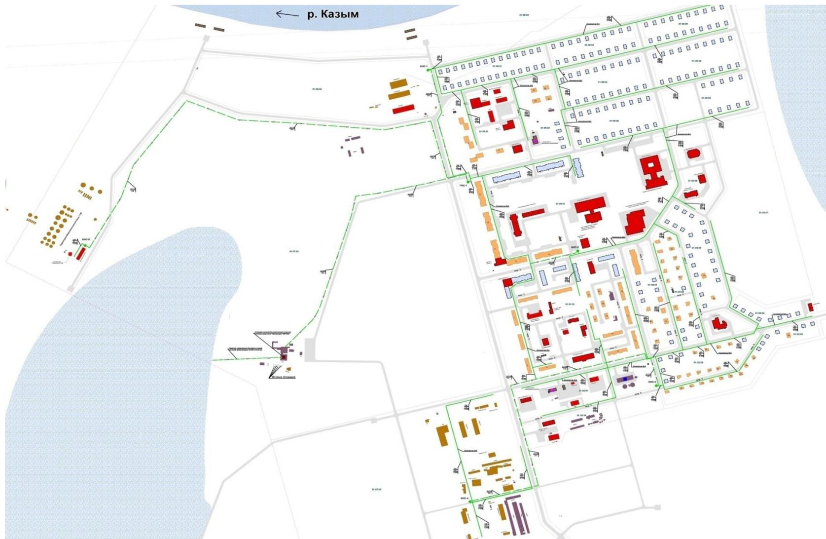
**Рис. 3.4.1 Структурированная схема водоотведения с.п. Верхнеказымский**
